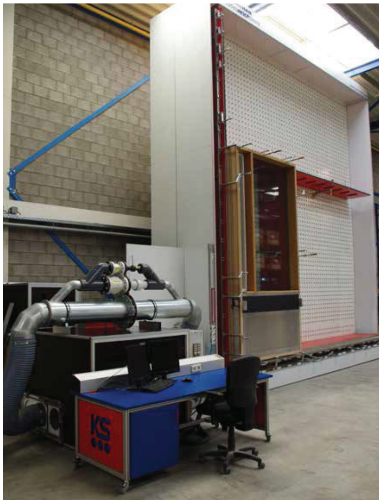
Testwand laboratorium Geldermalsen wind- en waterdichtheid.
